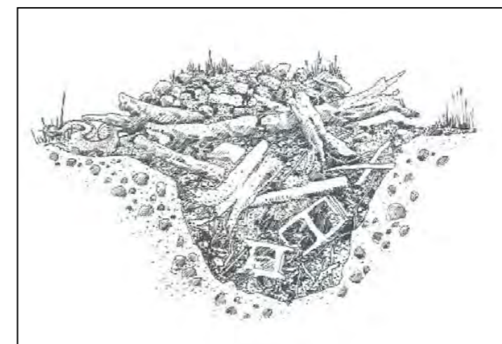
Figure 61 : Schéma type d'hibernaculum sur sol plat (Illustration d'un hibernaculum en milieux hydromorphes, CEREMA)
